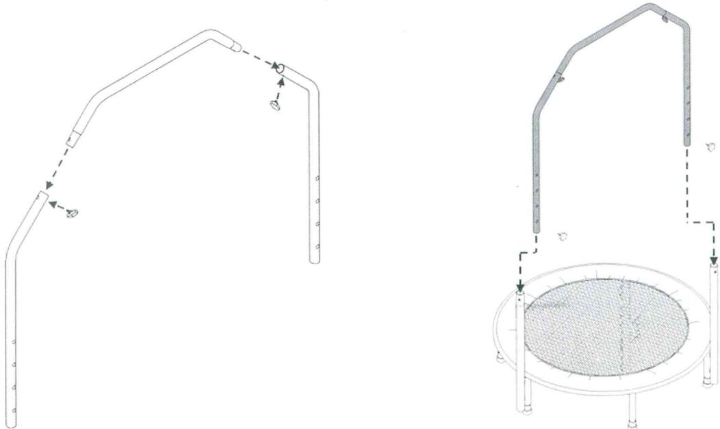
**3b)** Соедините деталь D с верхней частью обеих деталей С. При помощи детали Е скрепите детали С и D. Таким образом, получилась "верхняя часть конструкции".
