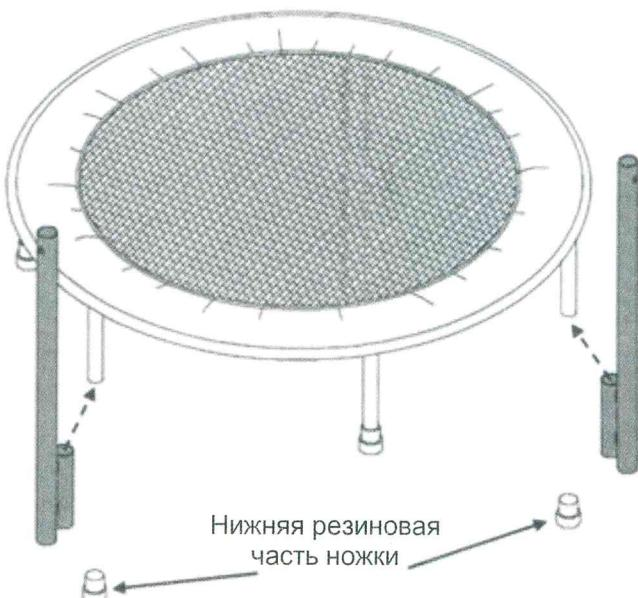
**3a)** Чтобы установить перекладину на батут модели 530, сначала снимите нижнюю резиновую часть с двух опорных ножек, как показано на рисунке. Затем вставьте каждую опорную ножку в деталь А и снова вставьте нижнюю резиновую часть в ножки.
