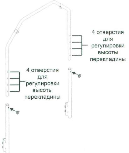
**3e)** Чтобы изменить высоту перекладины, выкрутите детали F, переместите верхнюю часть конструкции на нужную высоту, и затем опять вкрутите детали F. У перекладины есть четыре уровня высоты.
