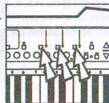
Громкость регулируется 2-я кнопками (см. рис.). При включении автоматически устанавливается нормальный уровень громкости, который Вы можете изменять, нажимая верхнюю или нижнюю клавиши
