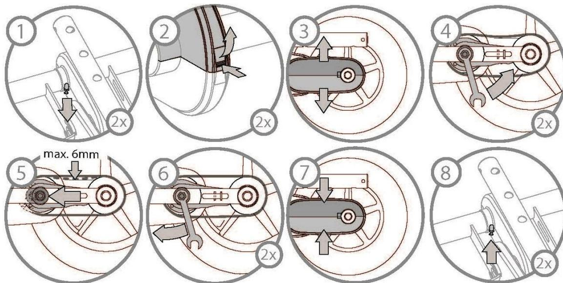
Натяжение передней цепи: снимите большой защитный кожух, ослабьте болты каретки на нижней стороне рамы. Натяните цепь, перемещая каретку с педалями вперед/назад. Затяните болты снова. Цепь натянута правильно, если посередине она может опуститься не более чем на 1 см вниз. Для проверки натяжения цепи достаточно снять нижнюю половину защитного кожуха.
